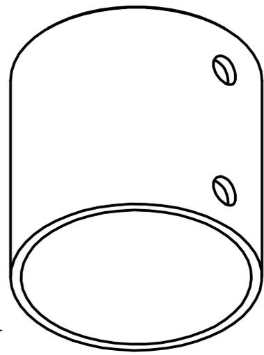
Grundkörper: Messing rohr 24mm außen
